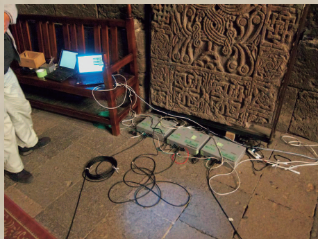
建築物の微かな揺れ（微動）を測って、構造的な特性を把握する
