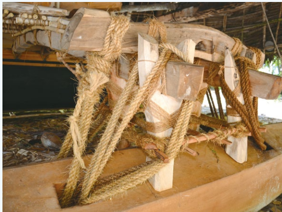
ココヤシ繊維のロープで固縛した外洋航海用カヌーのアウトリガー (2012年)
