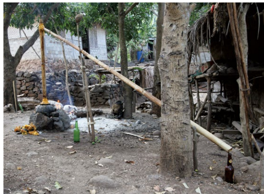
ヤシ焼酎アラックの蒸留装置。蒸留装置はごくシンプルな単式蒸留器である(2011年)
