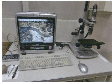
写真3 デジタル実態顕微鏡
