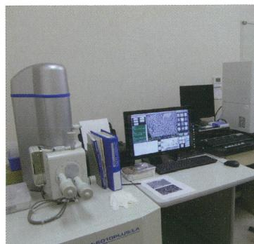
写真4 走査型電子顕微鏡
