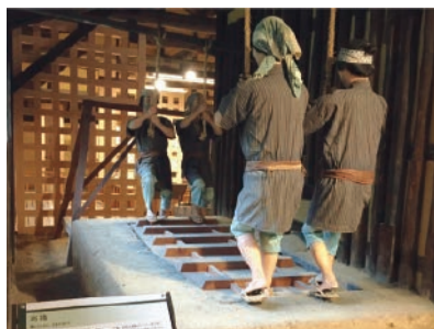
写真4 踏鞴(送風装置)模型
