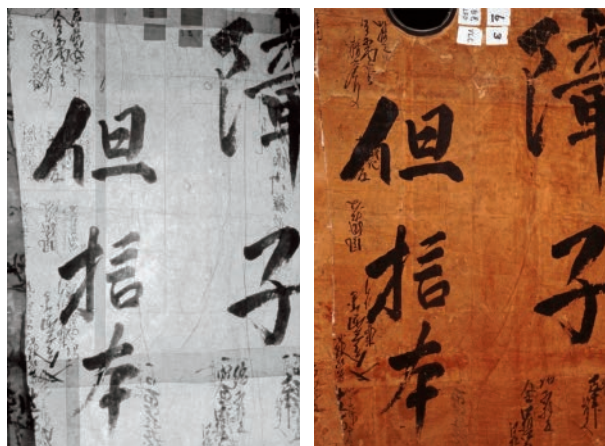
図 14 反射光撮影画像と透過光撮影画像の比較 (左) 白色光・反射光受光 (右) 近赤外光・透過光受光
