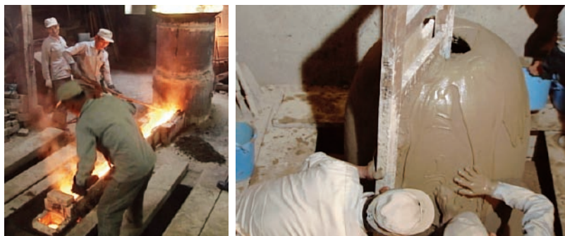
図 3 ビデオ『梵鐘づくりー滋賀県五個荘町ー』（国立民族学博物館） （左）鋳込み、（右）鋳型（中子）づくり
