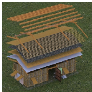
図9 3Dによる屋根の構造図
