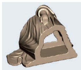
図5 3mmの厚みを残して中空化
