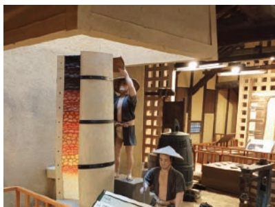
写真3 こしき炉(溶解炉)模型
