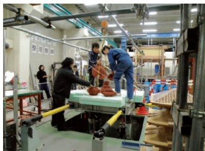
写真5 起震装置を用いた倒壊試験
