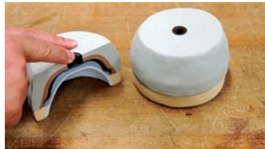
写真7 鑄型づくり模型と鑄型の断面
