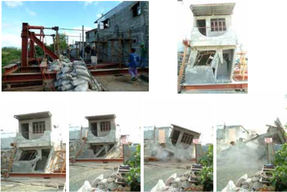
図3 住宅の水平載荷実験の様子
