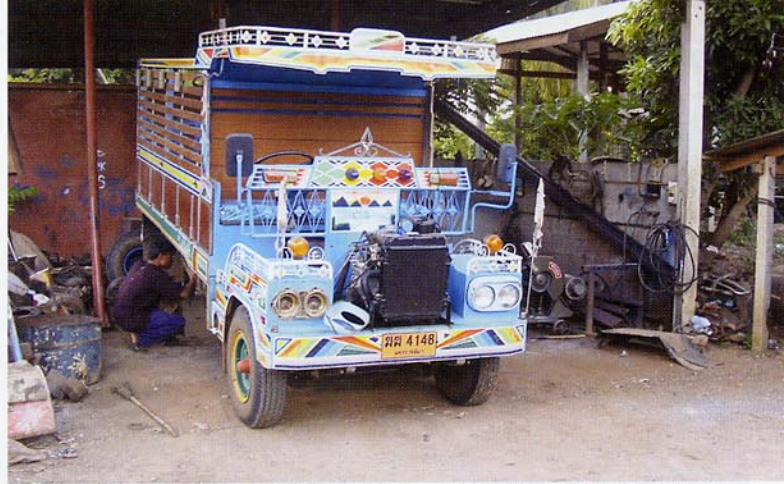
タイの手作りトラック「イタン」。農業用の汎用エンジンを使って駆動する。村の修理工場では、職人たちが独学で身につけたイタン作りをおこなっている
