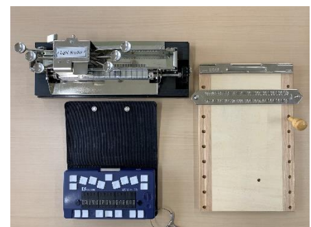
点字筆記具の変遷 (木製点字盤(右)、 点字タイプライター(左上)、 点字電子手帳(左下))
