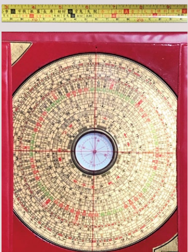
魯班尺(上)と羅盤(下)。吉凶の文字が入っており、吉の寸法または方角に合わせて測定する(筆者所蔵)
